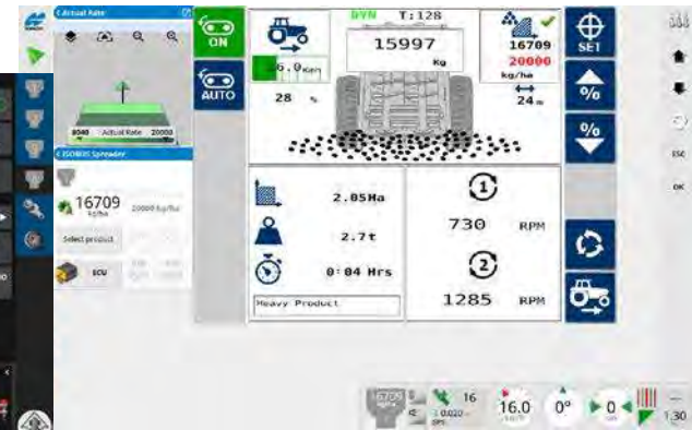
Horizon OS / ISOBUS ex : Guidage et régulation d'épandage de matière organique
